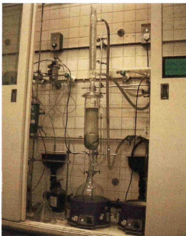
Fig. 4. Soxhlet apparatus.
