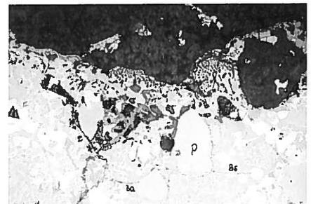
Abb. 19: Probe E 2 b/1. Auflicht, parallele Nicols. Im unteren Bildteil Steintropfen mit Pyrrhotin (P) sowie (FeCuBaK)-Sulfid (Ba). Bleisulfid (Bs), hier eutektisch mit (Ba), wird an der oberen Begrenzung des Steines von der hoch BaO-haltigen Matrix (dunkel) angegriffen
