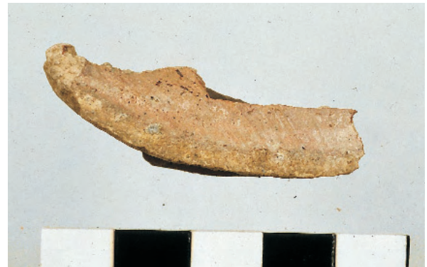
Abb. 8a-c: Bleiglätte-Kuchen von Thorikos (oben, Maßstab in cm) und D nnschliff eines ähnlichen Fragmentes mit silberreichem Blei-Tropfen (Mitte und unten).
