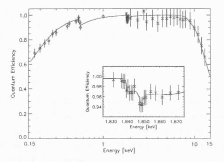
Figure 1.9: Quantum Efficiency of the pn CCD (Strüder et al 2001)
