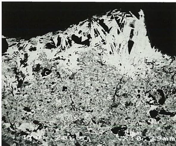
Abb. 7: Mikrophoto eines polierten Dünnschliffes durch die Finne an der Oberseite der Bleiglätte. Durch die Art der Aufnahme (Rückstreuelektronen am Rasterelektronenmikroskop) erscheint ein Material um so heller, je höher seine mittlere Ordnungszahl ist. Die hellen Bereiche sind reine Bleiglätte, während die calcium- und siliziumhaltige Grundmasse grau erscheint. Schwarz sind nicht ausgefüllte Hohlräume.
