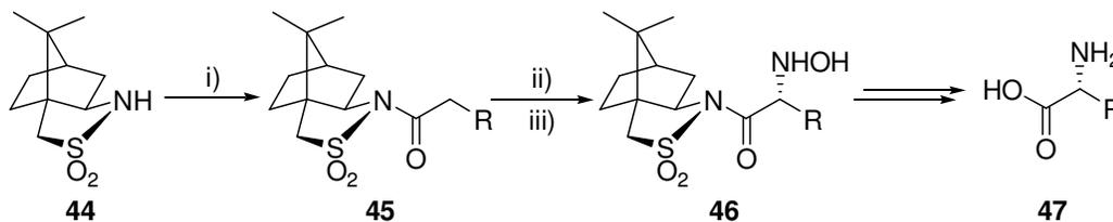
i) NaH, RCH<sub>2</sub>COCl. ii) NaN(SiMe<sub>3</sub>)<sub>2</sub>, iii) 1-chloro-1-nitrosocyclohexane. iii) 1N aq HCl, rt
